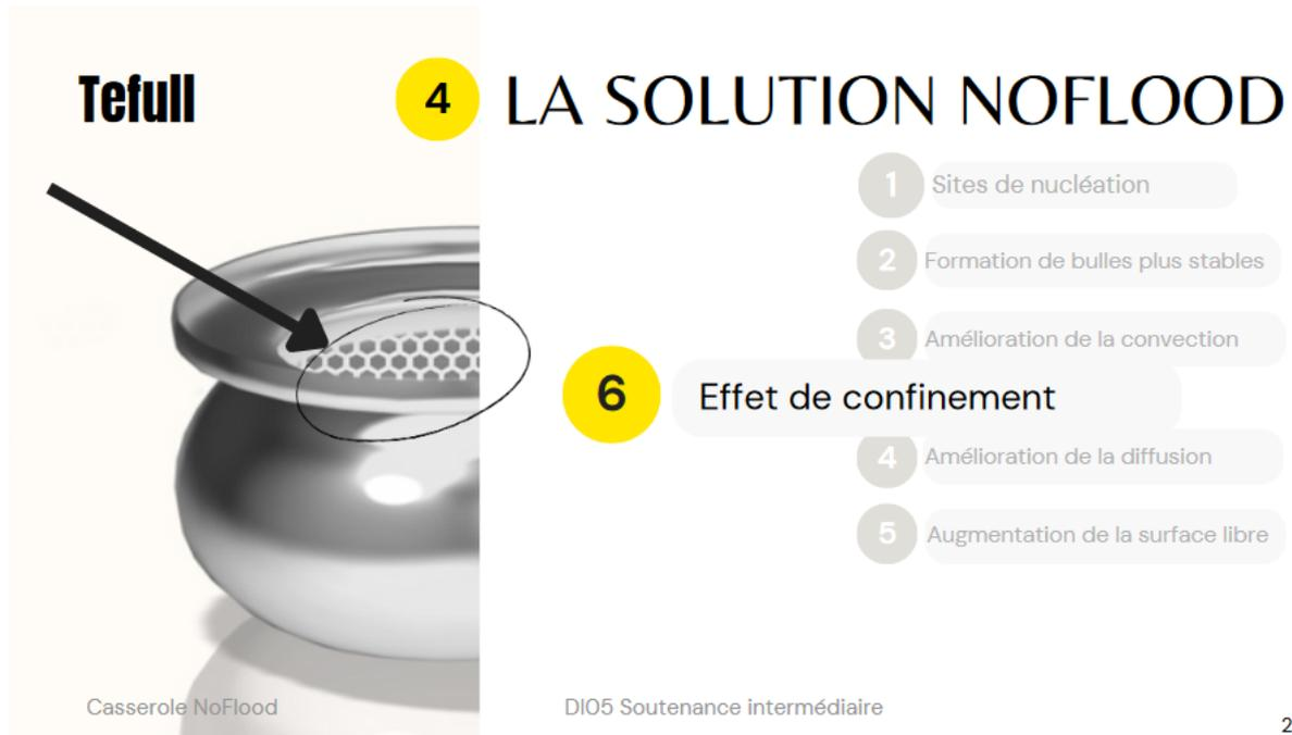
De plus, cela permet un **effet de confinement** car la rugosité de la surface retient la chaleur à proximité du liquide, dû à une meilleure rétention de la chaleur dans les creux et les aspérités de la surface favorisant alors une libération de vapeur plus contrôlée.
